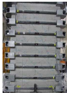
(a)引張鉄筋降伏時
