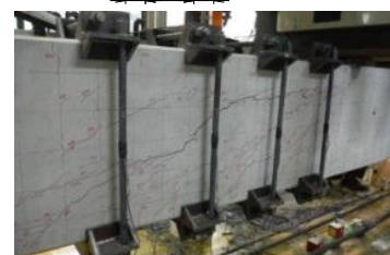
図3 最大荷重時破壊状況
