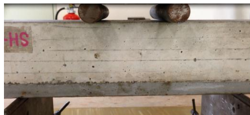
写真-1 曲げ強度試験
