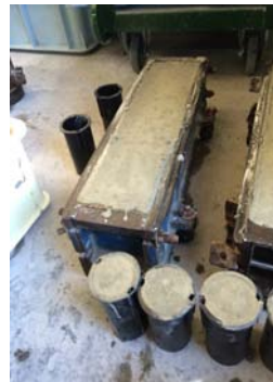
写真-6 GCL25%打設後
