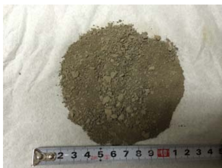
写真-1 使用したGCL細骨材
