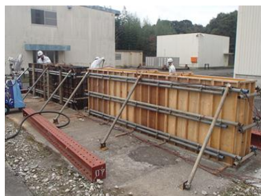
写真-2 実物大の型枠試験状況(左)と温度ひび割れ状況(右)
