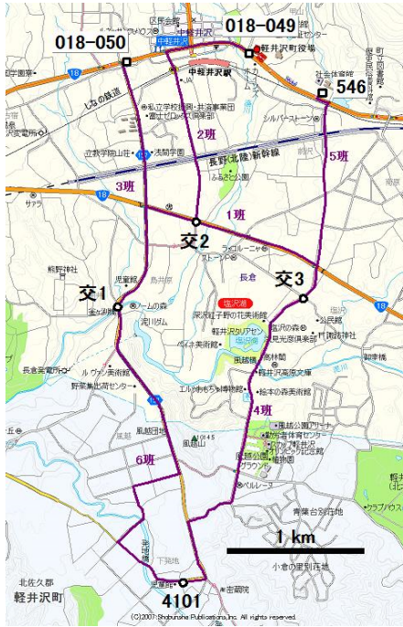
図 2 昇降式水準測量の平均図
