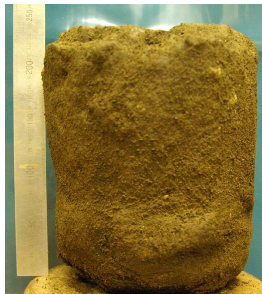
写真 4: Case6 の固結パイル
