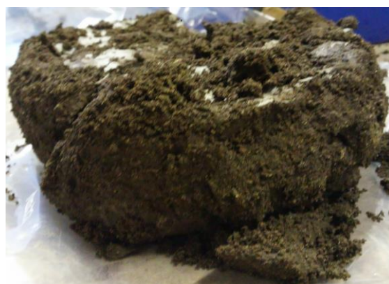
写真 3: 2 枚翼固結パイル様子
