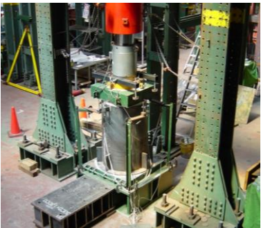
写真1 押抜き試験状況
