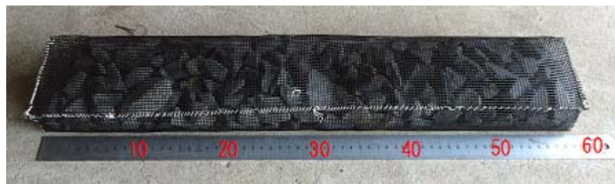
(b) ジオグリッド蛇籠工の模型 (単位: cm)
