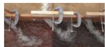
写真 7 オリフィス上流側に突起を付けた流況 (Case 9)
