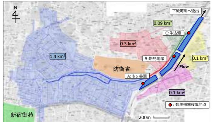
図-1 外濠(市ヶ谷濠～牛込濠)の集水域図および観測地点の位置図。
