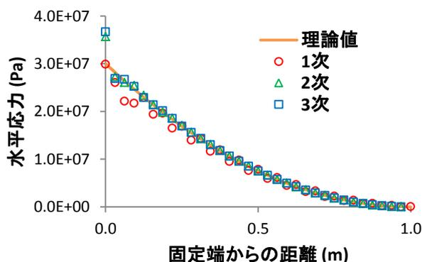
図5 はり上縁の水平応力の解析結果
