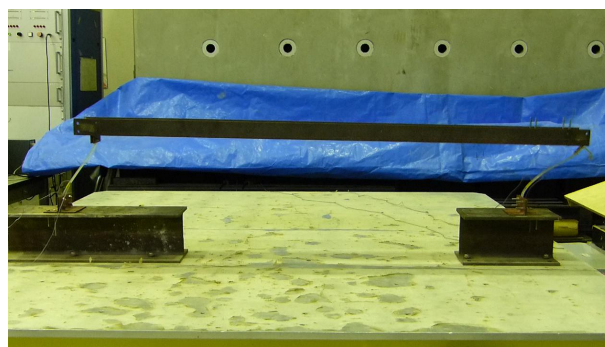
写真-2 橋梁模型 1 の倒壊寸前時
