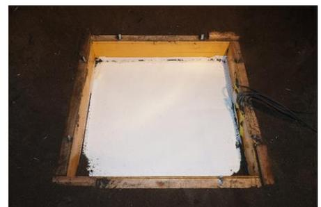
図-5 Case3 爆発後の EPS材 (破損なし)
