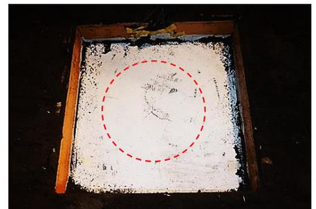
図-4 Case2 爆発後の EPS材 (ひび割れ)
