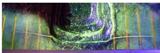
写真-3 止端部からの疲労き裂
