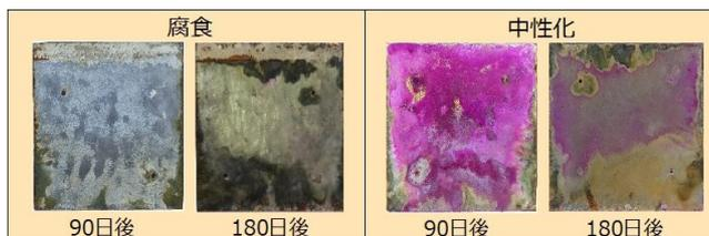
図-4 接触面に付着がない試験体の中性化及び腐食確認結果
