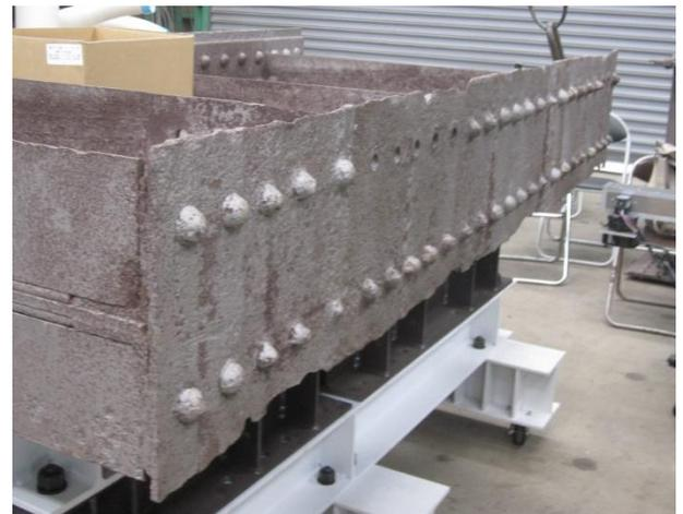
図-4 腐食形状計測状況
