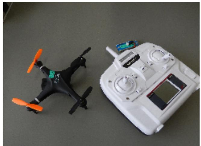
写真5 ベトナムで利用した小型マルチローター型UAV
