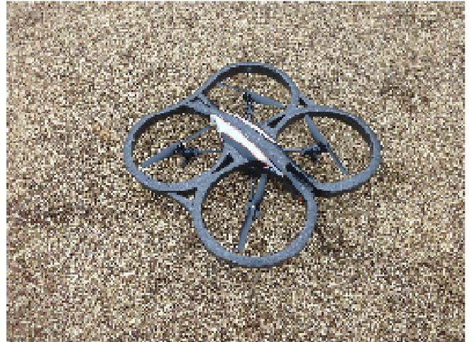
写真4 UAV：マルチローター例
