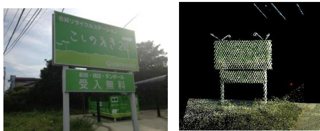
図－2 計測した看板の写真と点群データの例
