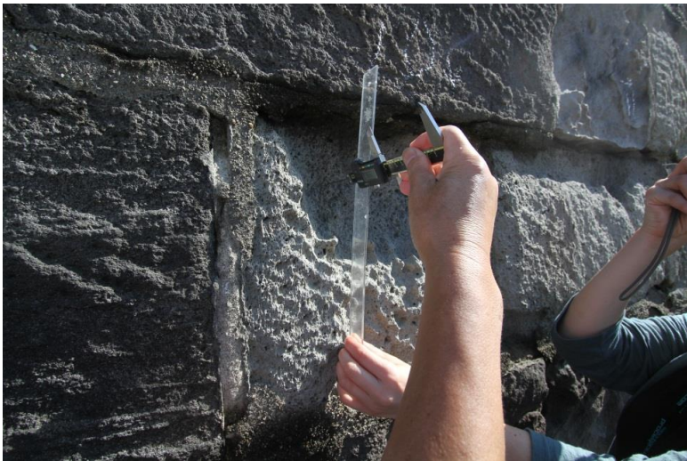
写真-4 ノギスによる最大侵食量の測定 (No.10)
