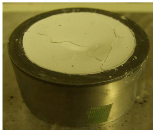
写真-2 最大密度試験時の乾燥させたガラスビーズ
