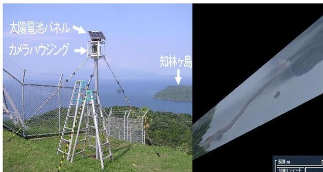
図-2 定点カメラ(左)と射影変換画像(右)
