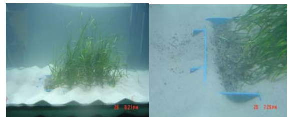
写真-1 実アマモ周りの砂漣発達と局所洗掘
