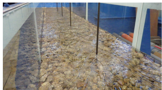
b) 平水流量( 5.0 \text{ m}^3/\text{s} )を想定した転流工内の流れ
