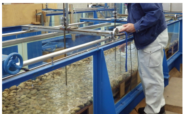
a) 水路内のポイントゲージによる水面形測定の様子 b) 水路内のプロペラ流速計による流速測定の様子
