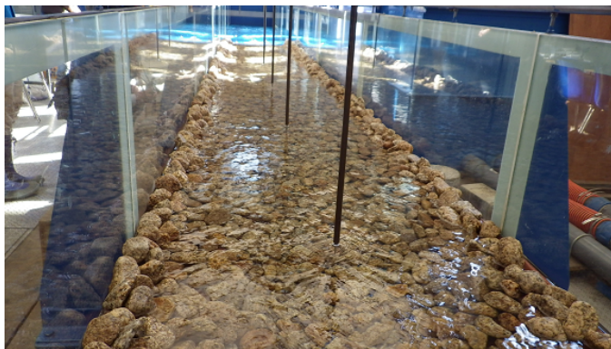
a) 水路内のポイントゲージによる水面形測定の様子 b) 水路内のプロペラ流速計による流速測定の様子
