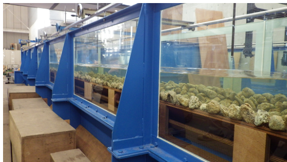
a) 豊水流量( 11.8 \text{ m}^3/\text{s} )を想定した転流工内の流れ 写真5 1/230 勾配を有する転流工内の流れ
