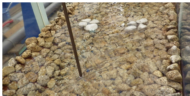
写真4 緩勾配水路における流れの緩急増進対策としての石組み台形断面水路中の巨石の設置
