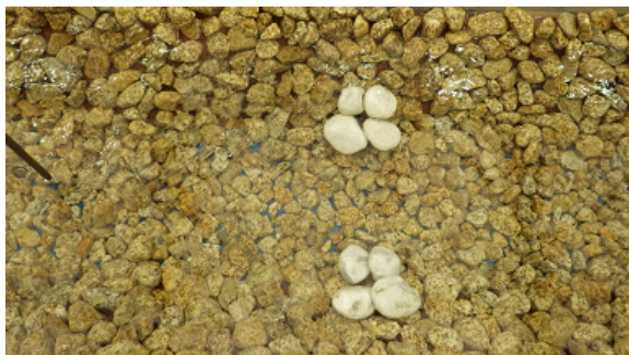
写真4 緩勾配水路における流れの緩急増進対策としての石組み台形断面水路中の巨石の設置
