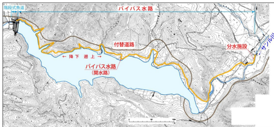
図1 サンルダム上流側に整備されるバイパス水路
