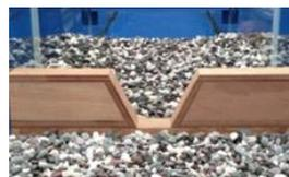
写真1 台形断面スリットの模型
