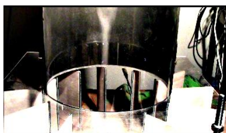
図2 層流渦の可視化 \theta=15 度
