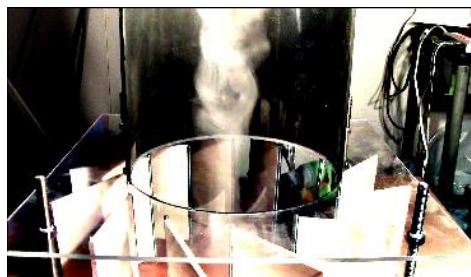
図3 乱流渦の可視化 \theta=50 度
