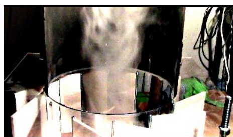
図4 渦の拡大 \theta=70 度
