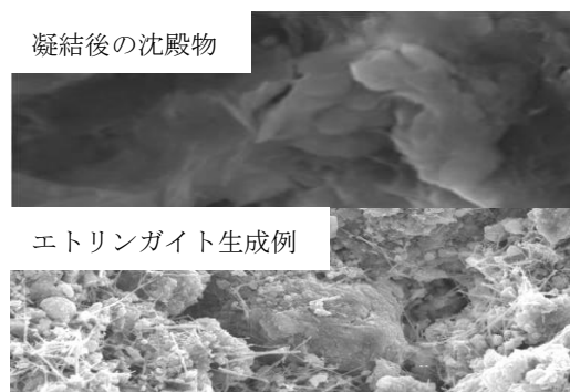
図4 沈殿物の様子(上)と エトリンガイト発生例(下)
