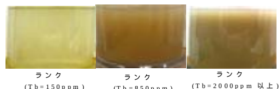
写真 1 洗浄水の濁度状況
