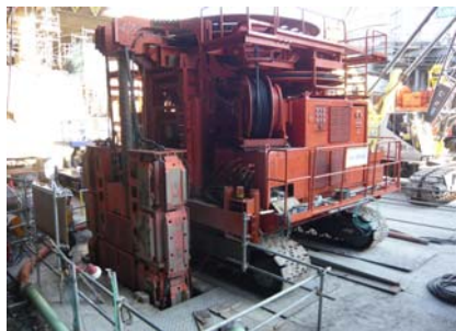
写真2 低空頭掘削機
