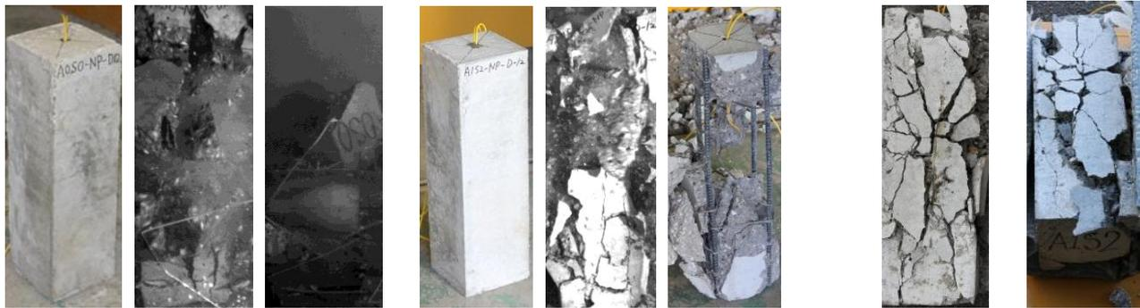
試験前 破砕中 (1) A0S0 破砕後 試験前 破砕中 (2) A1S2 破砕後 (1) A1S1 (2) A1S2
