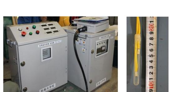
図-2 放電破砕装置とエコリッジ
