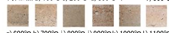
写真-2 W/C=45%, 各加熱温度での供試体表面の様子
