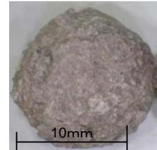
写真-1 断熱材廃棄物 写真-2 作製した代替骨材
