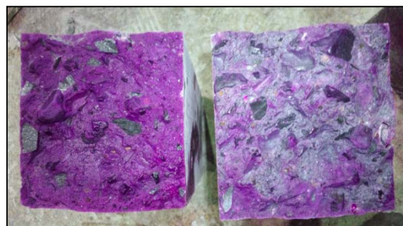
写真-1 供試体中のアルカリの残存状況 (左：水中養生、右：加熱養生)
