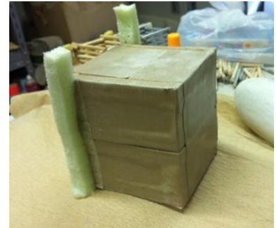
図-1 重力式土留め模型(長方形)
