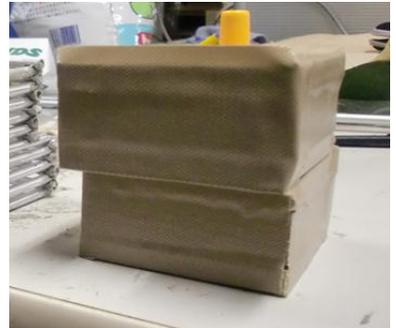
図-2 重力式土留め模型(段型)
