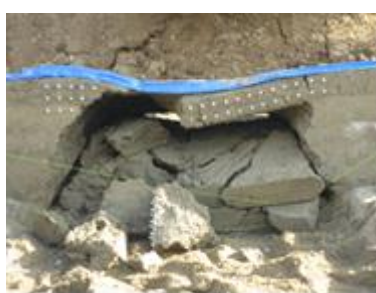
図-7 砂層の掻き出し 100%の BMS 層の状況（左から、GN 無空洞 5cm、空洞 20cm、GN 有空洞 20cm）
