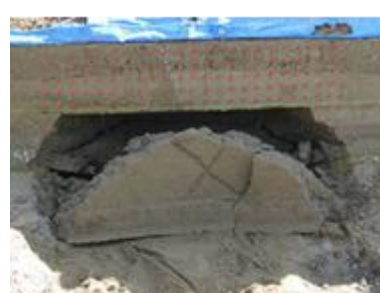
図-7 砂層の掻き出し 100%の BMS 層の状況（左から、GN 無空洞 5cm、空洞 20cm、GN 有空洞 20cm）
