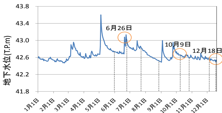
図-5 観測井の地下水位データ
