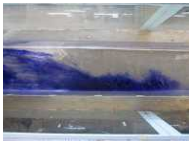
写真-1 A の実例 (勾配 1/200, 流量 0.5 l/s)
