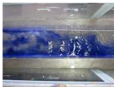
写真-2 B の実例 (勾配 1/400, 流量 4.0 l/s)
