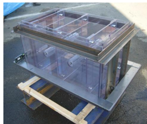
写真 1 グラウト充填試験供試体
