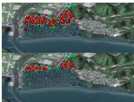
図－1 津波遡上解析結果（2600 秒後，上：耐力大，下：耐力小）
