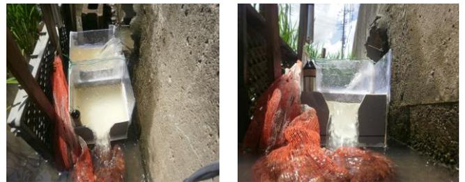
図-1 流量測定に用いた60°三角堰
