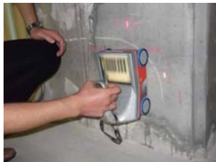
写真-2 RC レーダーによる探査
