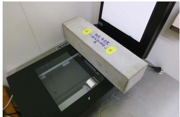
写真-1 長さ変化供試体の撮影の様子
