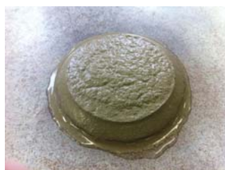
写真-2 引き抜きフロー試験時の様子 (40-10)
