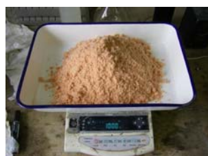
写真-1 断熱材廃棄物
