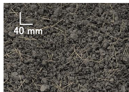
図-2 PVA 繊維の攪拌状況
