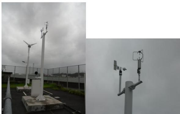
写真-1 風向風速計の設置状況
