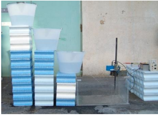
図-6 円錐形水時計の模型
