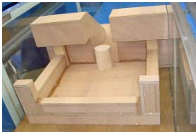
写真3 スリットおよび流量調整用プールの6分の1縮尺模型
