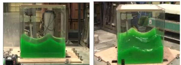
(a) 加振方向角 0° (b) 加振方向角 45°
