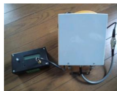
図-7 外部アンテナ
