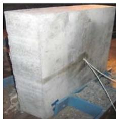
写真-3 放電カートリッジの RC 壁への設置状況
